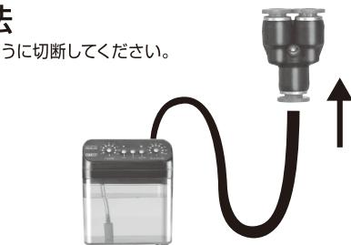
2. 本体側の耐圧チューブを分岐パートの二股にならないように、チューブが抜けなくなるまでしっかりと差し込む。
