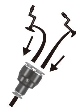
3. ノズル側の耐圧チューブと新しく追加するノズルの耐圧チューブを、分岐パートにそれぞれしっかりと差し込む。
