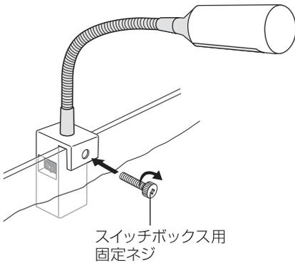
水槽の内側からスイッチボックス用固定ネジで傾かないように止める。
