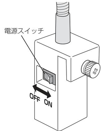
3. スイッチボックスの電源スイッチをONにする。
