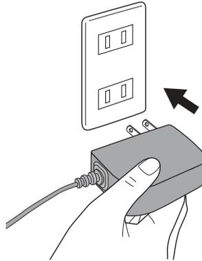
2. ACアダプターの差し込みプラグをコンセントに接続する。
