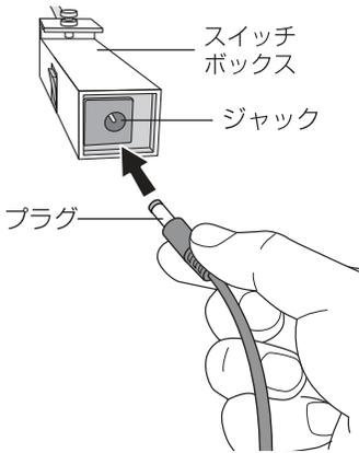
1. スイッチボックスのジャックにACアダプターのプラグを差し込む。
