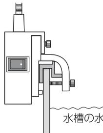
枠幅17mm以下の水槽に取り付けることができます。
