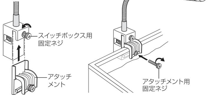
1.アタッチメントをスイッチボックスの図の位置に差し込み、スイッチボックス用固定ネジで止める。
