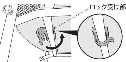
3. 後輪側のフレームにロック受け部をはめ込み、ロックを閉じる。
