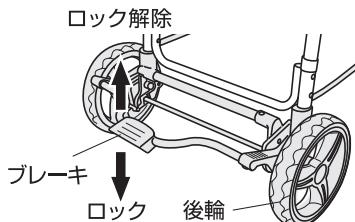
1. ブレーキを下げるとき、左右後輪のブレーキ溝にブレーキの両端がはまり後輪がロックされる。
