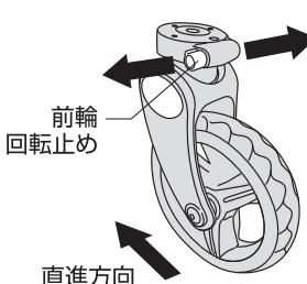
1. 前輪を直進方向むけて、前輪回転止めを「LOCK」の方向にスライドさせると、前輪が横回転しなくなり直進方向にのみ進むようになる。
