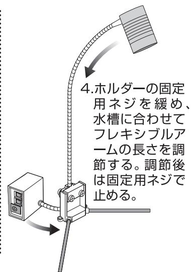
4.ホルダーの固定用ネジを緩め、水槽に合わせてフレキシブルアームの長さを調節する。調節後は固定用ネジで止める。
