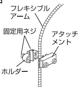
2.アタッチメントにフレキシブルアームをセットし、ホルダーを取り付けて固定用ネジで止める。
