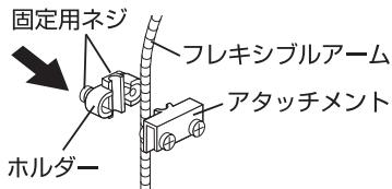
1.アタッチメントにフレキシブルアームをセットし、ホルダーを取り付けて固定用ネジで止める。
