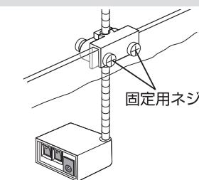
2.水槽にアタッチメントを取り付け、内側から固定用ネジで傾かないように止める。
