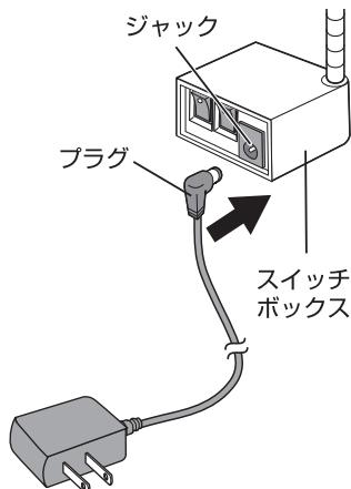
1.スイッチボックスのジャックにACアダプターのプラグを差し込む。
