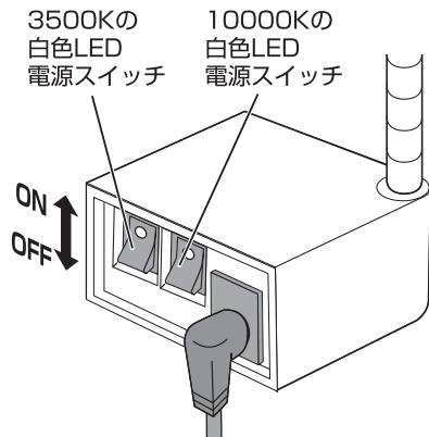
3.スイッチボックスの電源スイッチをONにする。
