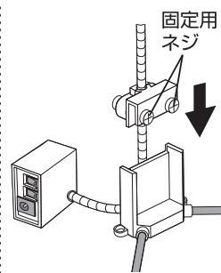
3.スタンド用ベースにアタッチメントを取り付け、固定用ネジで止める。
