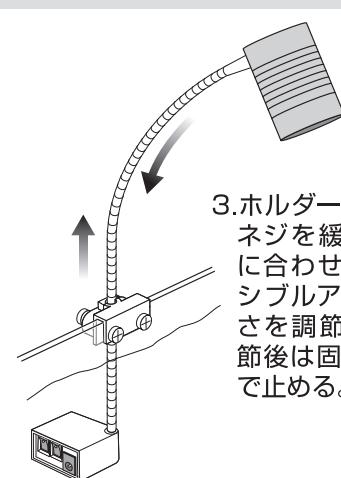
3.ホルダーの固定用ネジを緩め、水槽に合わせてフレキシブルアームの長さを調節する。調節後は固定用ネジで止める。
