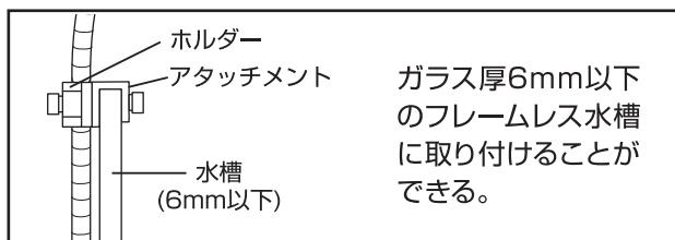
ガラス厚6mm以下のフレームレス水槽に取り付けることができる。
