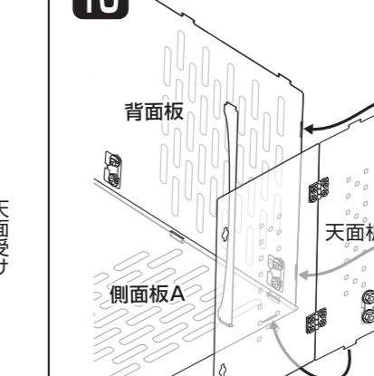
背面板・側面板A上部の連結穴に天面板の連結爪を差し込み、ゴムリングで固定する。(350は3ヶ所、460は4ヶ所)
