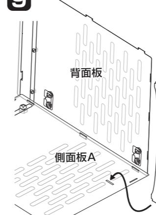
⑧で組み立てたものを側面板Aを下にして、天面受けの連結爪を側面板Aに差し込み、ゴムリングで固定する。(1ヶ所)
