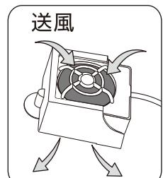
●ファンの突起が上側にくるようにアタッチメントに取り付けると排気、ファンの突起が下側にくるように取り付けると送風になります。
