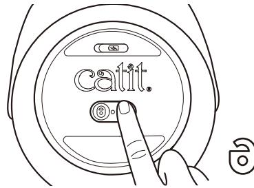
スリープモードを解除し、ロック解除ボタンを短く押すと真空解除が開始される。
