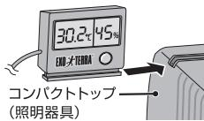
エキゾテラのコンパクトトップ（照明器具）を使用している場合はコンパクトトップ上部の溝に、本体をスライドしてはめ込んで設置する。
